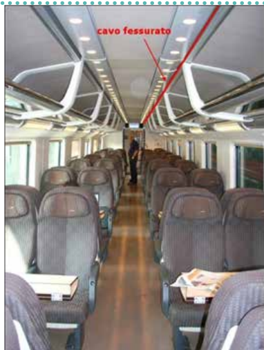
Figura 1: Disposizione del cavo fessurato nella carrozza (ESAV 9699 e ESAV 9526)
